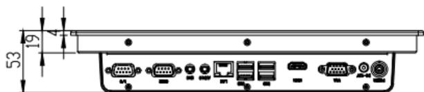
注解: 1.建议开孔尺寸长287±0.5mm 宽225±0.5mm
